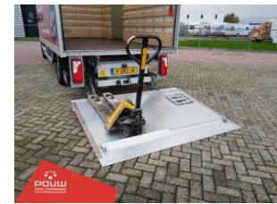
laadklep met afrolbeveiliging en markeerplaats voor medewerker
