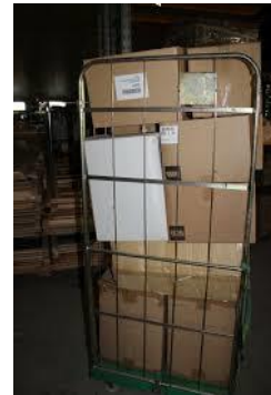
foutief beladen rolcontainer
