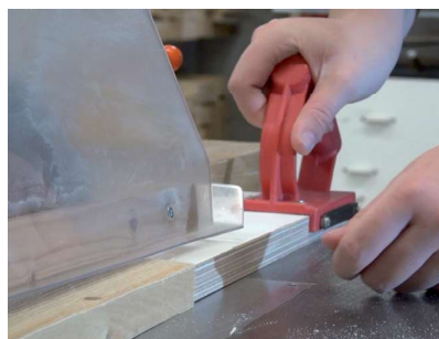
Plaatmateriaal: zaag 10 mm boven de dikte van het plaatmateriaal instellen
